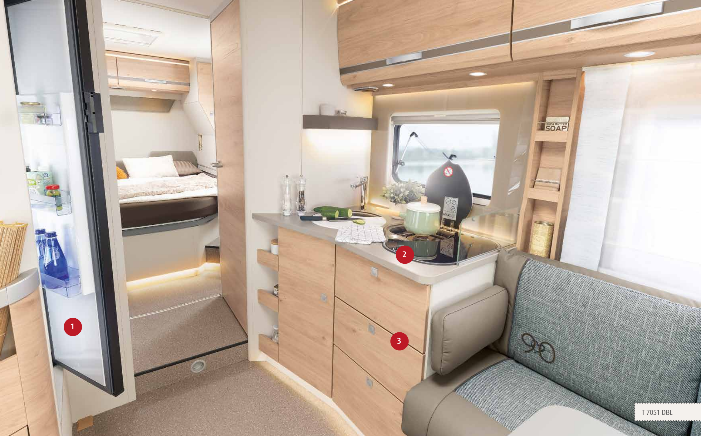
1 Frigorífico con congelador de 137 l con selección automática de energía AES. El sistema pasa automáticamente a la mejor fuente de energía disponible (gas, 230 V, 12 V)
