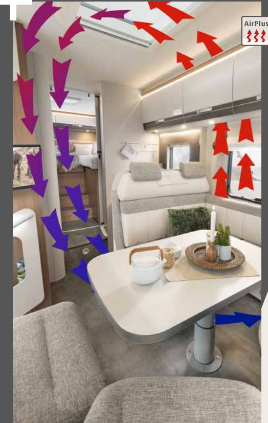
El sistema AirPlus evita la condensación de agua detrás de los armarios altos
