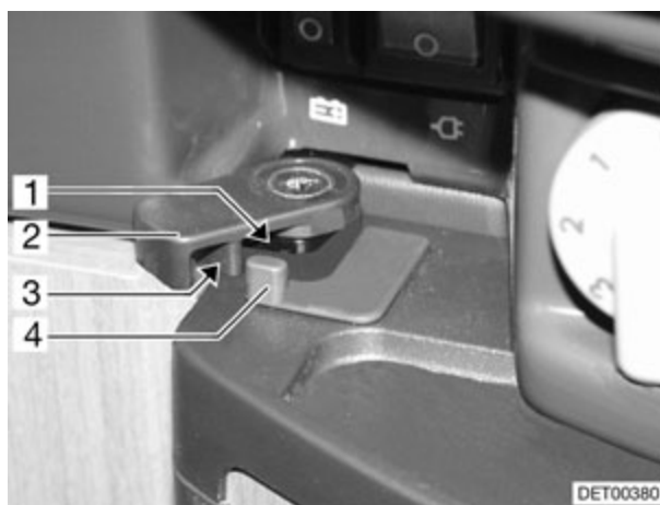
Fig. 123 Bloqueo de la puerta del frigorífico (variante 2)
