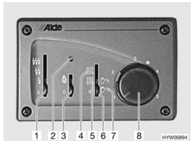
Fig. 100 Unidad de mando para calefacción de agua caliente
