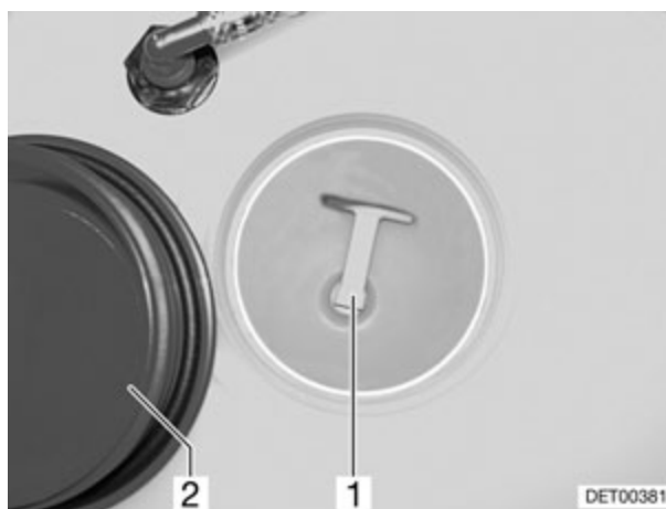
Fig. 131 Tapa de cierre del tubo de llenado de agua potable
