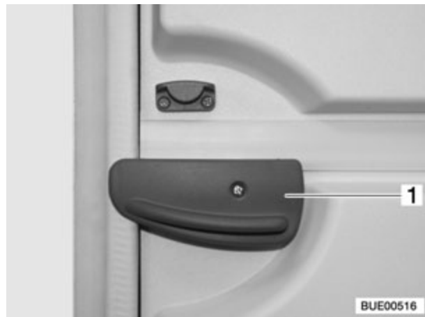
Fig. 24 Palanca de bloqueo de la puerta, parte inferior de la puerta
