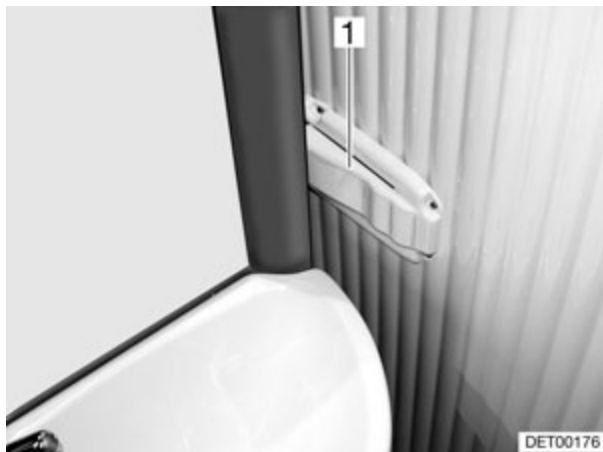
Fig. 185 Inodoro Vario, bloqueo de la pared de la ducha
