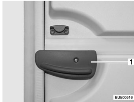
Fig. 25 Palanca de bloqueo en la parte inferior de la puerta
