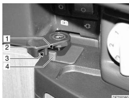
Fig. 133 Bloqueo de la puerta del frigorífico (Dometic de la serie 4 con palanca de bloqueo)
