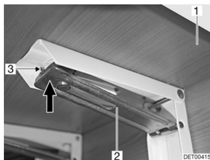
Fig. 58 Apoyo de la prolongación del banco de asiento
