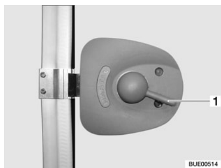
Fig. 23 Cerradura de la puerta de entrada, en el interior, abierta
