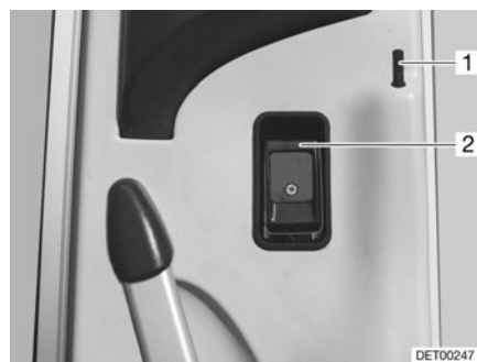
Fig. 32 Cerradura de la puerta de entrada, en el interior
