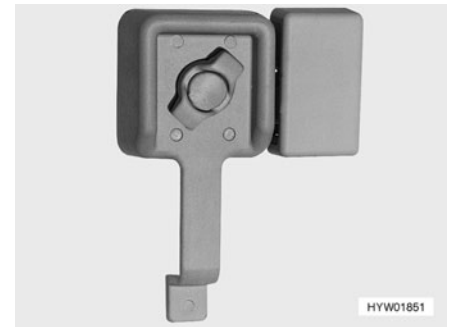
Fig. 31 Cerradura de la puerta de entrada, en el interior, bloqueada
