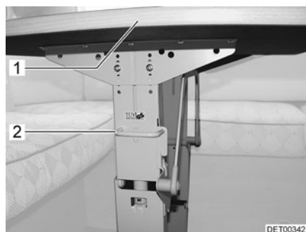
Fig. 66 Bloqueo mesa abatible con estribo
