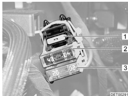
Fig. 121 Fusibles para la batería del motor de arranque (Renault)
