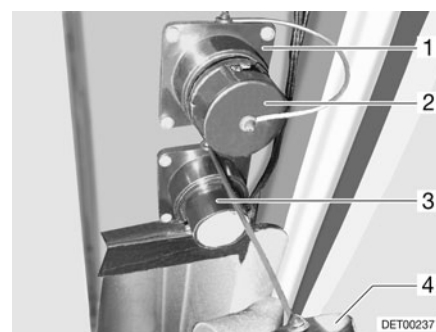
Fig. 179 Conexión de salida de aguas residuales
