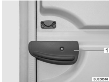
Fig. 25 Palanca de bloqueo en la parte inferior de la puerta
