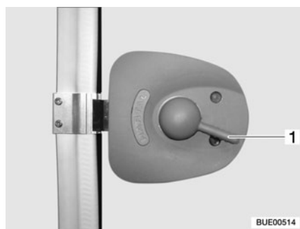
Fig. 23 Cerradura de la puerta de entrada, en el interior, abierta
