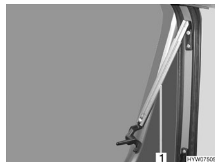
Fig. 39 Ventana abatible con soportes automáticos, abierta
