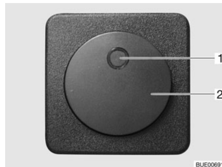
Fig. 156 Conmutador de mando de la bomba de circulación adicional
