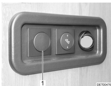
Fig. 85 Interruptor de luz iluminación entrada
