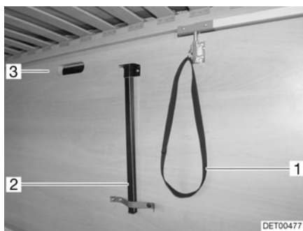
Fig. 93 Apoyo y desbloqueo
