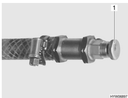
Fig. 224 Válvula de purga de la calefacción de agua caliente
