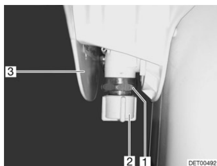
Fig. 173 Válvula del inodoro por vacío
