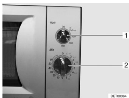
Fig. 139 Elementos de mando del horno microondas
