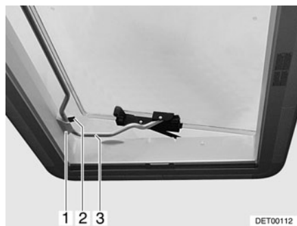
Fig. 55 Claraboya Heki en posición de ventilación 2
