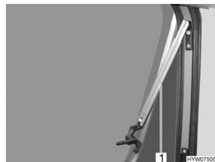
Fig. 39 Ventana abatible con soportes automáticos, abierta
