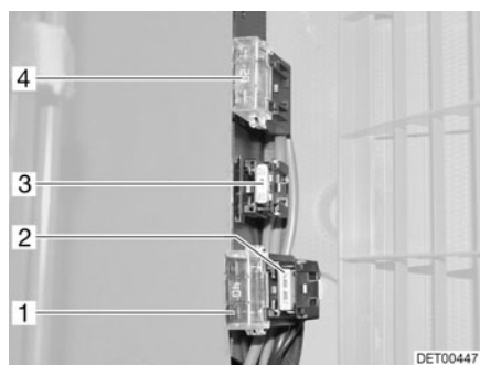
Fig. 145 Fusibles en la batería del habitáculo (Fiat)
