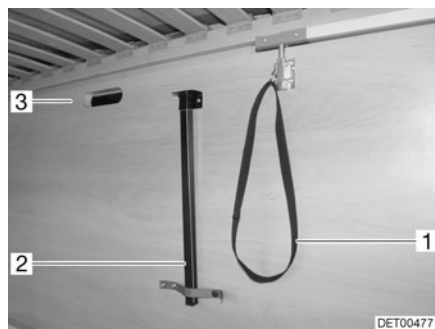
Fig. 100 Apoyo y desbloqueo
