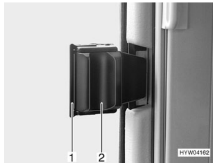
Fig. 48 Ventana corredera con con bloqueo corredizo
