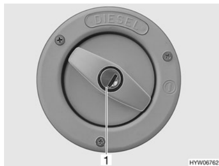
Fig. 29 Tapa de cierre para el tubo de llenado de combustible
