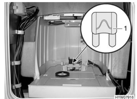
Fig. 149 Fusible del inodoro Thetford (alternativa)
