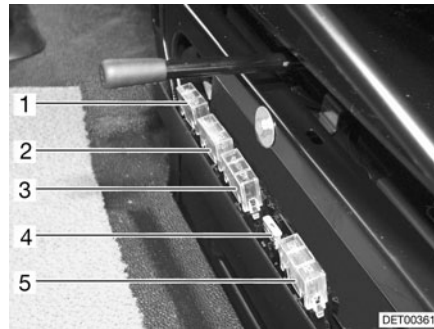
Fig. 146 Fusibles delante del asiento del conductor (Ford)
