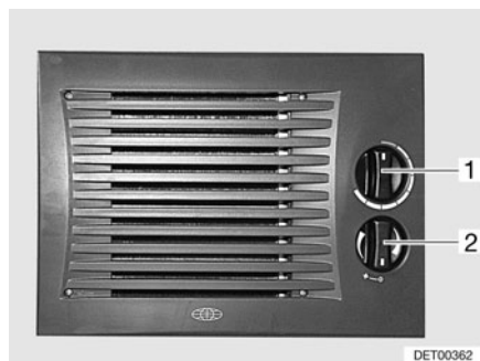
Fig. 166 Elementos de mando termo-cambiador adicional
