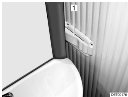
Fig. 237 Inodoro Vario, bloqueo de la pared de la ducha
