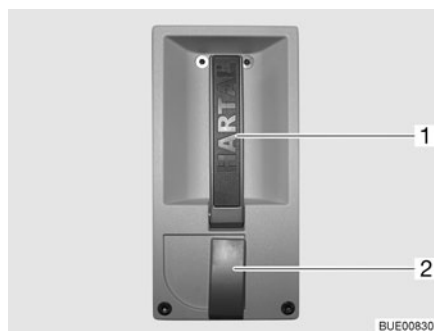
Fig. 38 Cerradura de la puerta de entrada, en el interior
