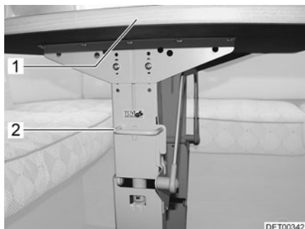
Fig. 82 Bloqueo mesa abatible con estribo
