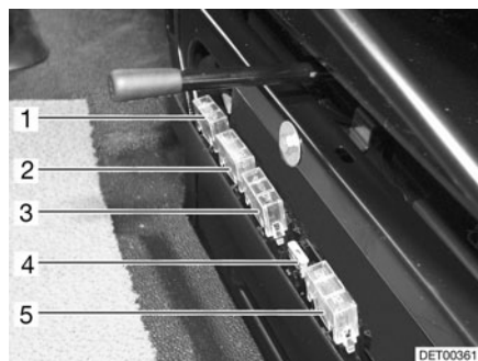
Fig. 143 Fusibles delante del asiento del conductor (Ford)
