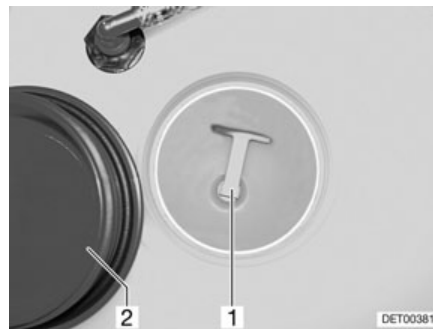
Fig. 159 Depósito de agua
