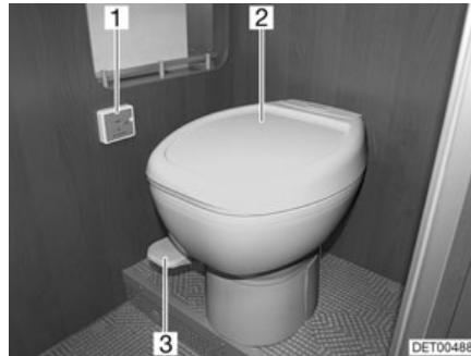
Fig. 170 Inodoro por vacío
