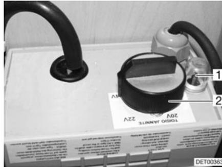
Fig. 190 Regulador para calentamiento eléctrico del piso
