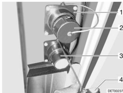
Fig. 236 Conexión de salida de aguas residuales
