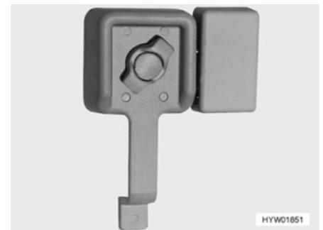
Fig. 37 Cerradura de la puerta de entrada, en el interior, bloqueada
