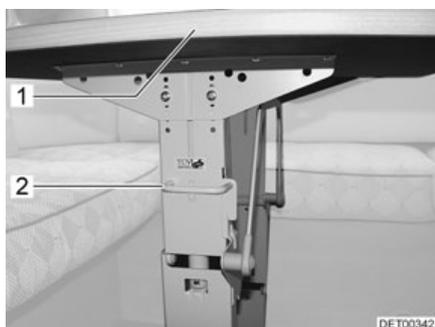
Fig. 83 Bloqueo mesa abatible con estribo
