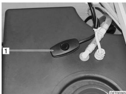
Fig. 228 Interruptor para bomba de agua
