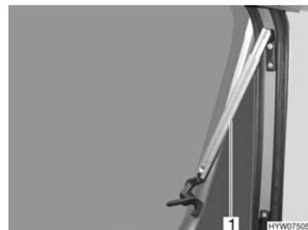
Fig. 55 Ventana abatible con soportes automáticos, abierta
