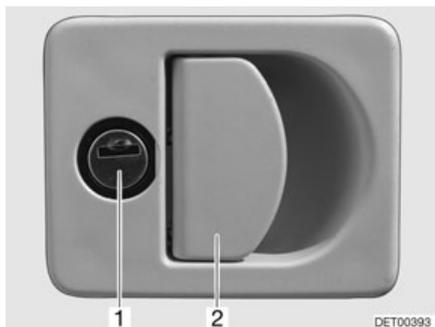
Fig. 46 Cerradura de la trampilla con tirador concha
