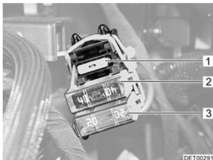
Fig. 167 Fusibles para la batería del motor de arranque (Renault)
