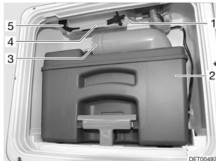
Fig. 265 Tubo de desagüe del depósito de agua del inodoro
