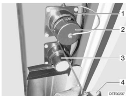
Fig. 234 Conexiones de salida de agua y de aguas residuales
