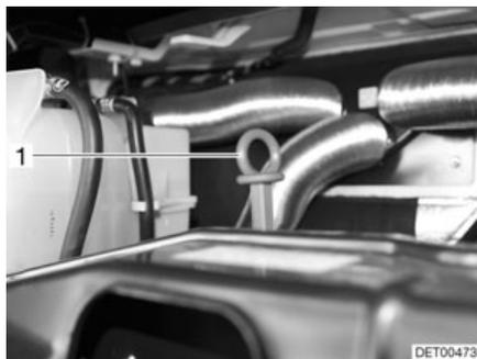
Fig. 29 Varilla del nivel de aceite (modelo I)
