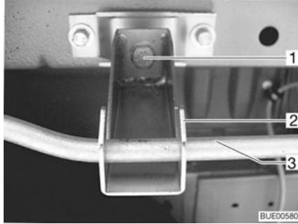
Fig. 287 Soporte para la rueda de repuesto debajo del vehículo
