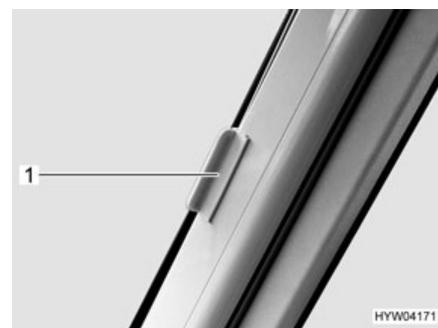
Fig. 22 Bloqueo estor plegable luna delantera (modelo I)
