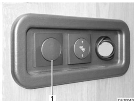
Fig. 93 Interruptor de luz iluminación entrada
