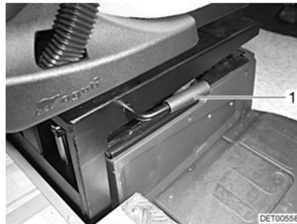
Fig. 13 Ajuste de la altura de asiento
