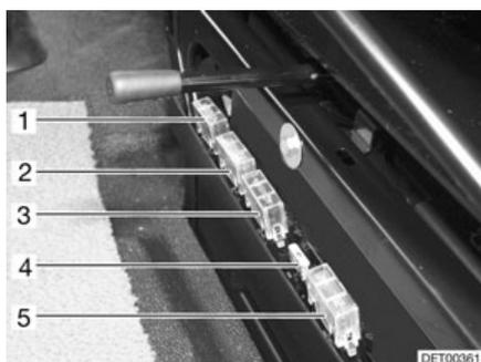
Fig. 169 Fusibles delante del asiento del conductor (Ford)
