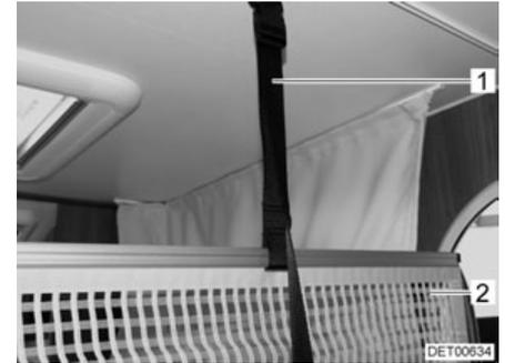
Fig. 102 Soporte red de seguridad
