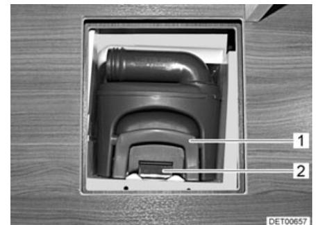
Fig. 262 Acceso al depósito de aguas fecales, abierto
