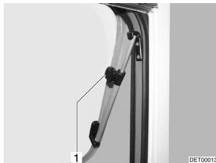
Fig. 52 Ventana abatible con soportes giratorios, abierta
