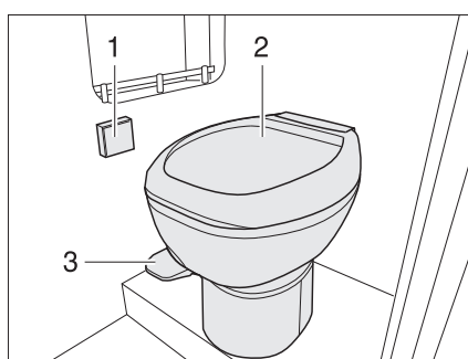
Fig. 157 Inodoro por vacío
