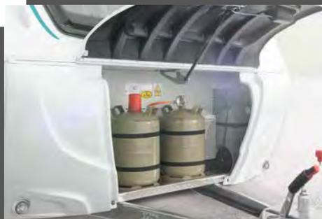
Compartimento para 2 bombonas de gas de 11 kg con resistente base de chapa estriada
