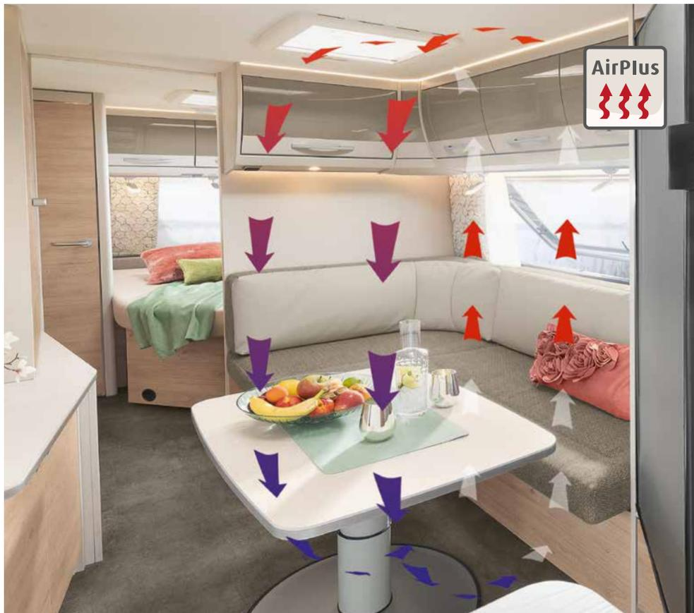
El sistema AirPlus de circulación de aire por detrás de los armarios altos evita una condensación de agua
