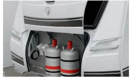
» Cofre de gas con base de chapa estriada y puerta de apertura vertical
