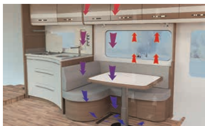
» AirPlus, sistema de circulación de aire detrás de los armarios altos
